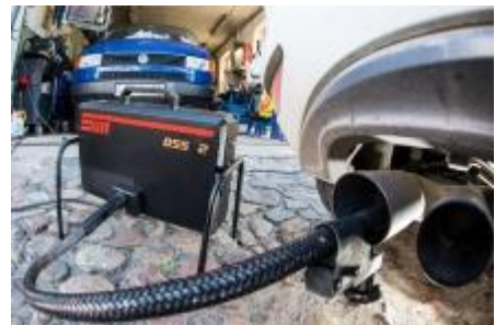
In einer Werkstatt werden die Abgaswerte eines Diesel-Pkws gemessen (© picture-alliance/dpa)
